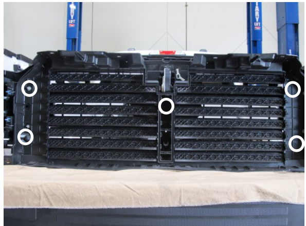
Fig. 1-W: Remove grill nuts
