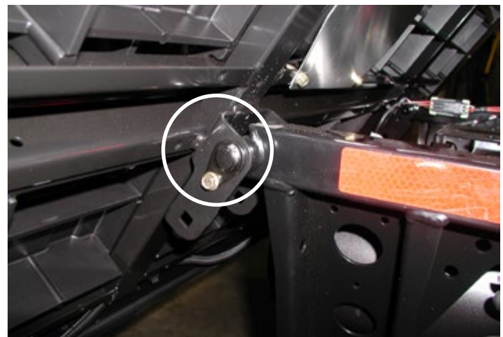
Remove Hinge Pins
