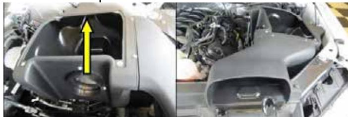
**2018 Model Air Filter Installation:**
