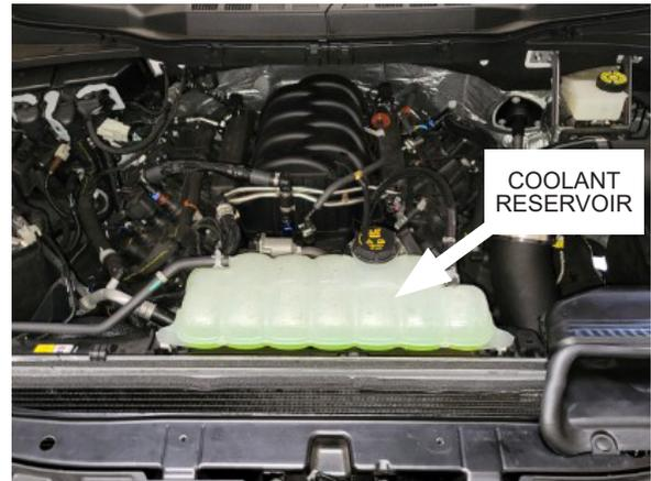
Fig. 7-B: Refill coolant
