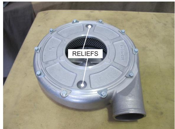
Fig. 7-B: Reinstall carburetor hat base
