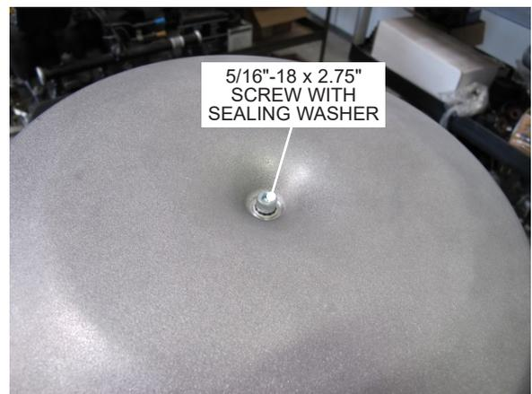
Fig. 7-E: Secure carburetor hat
