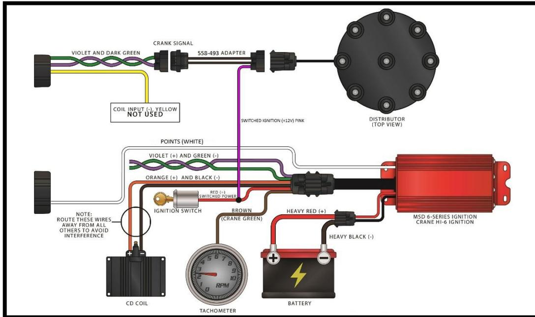
**HOLLEY DUAL SYNC DISTRIBUTOR PINOUT:**
